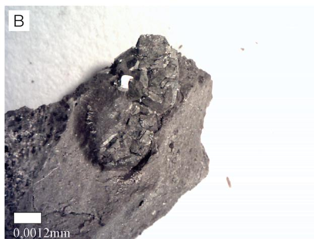
**Figura 4.** (A) Agregados de pirita interestatal identificada na amostra GDF 19; (B) fotografada à lupa binocular.
