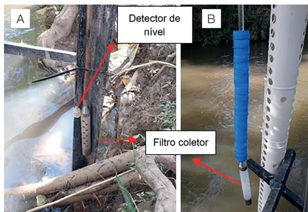
**Figura 3.** (A) Amostragem fixa de água e sedimentos. (B) Adaptação para flutuabilidade do filtro coletor a 40 cm de profundidade em relação à superfície da água.
