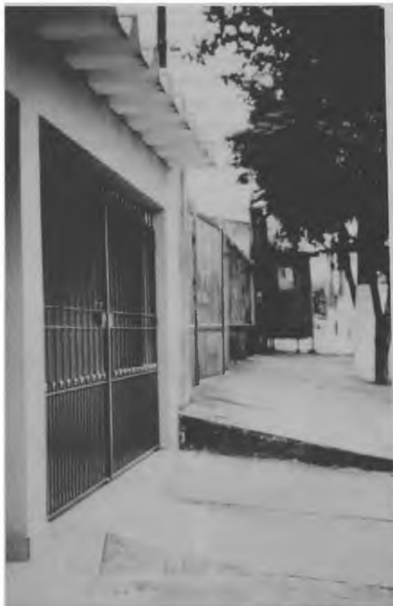
Figs. 55 e 56 - Cada lote resolve individualmente seu acesso à garagem. Mesmo que a rua seja relativamente plana as rampas de acesso às garagens são feitas sobre o passeio público. Como resultado, há uma grande descontinuidade física dos passeios ao longo da via, obrigando o pedestre a duas alternativas: ou fica subindo e descendo degraus - que às vezes são extremamente altos - ou anda na rua. O espaço público se submete às exigências do espaço privado
