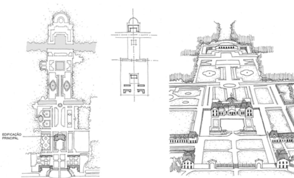
**Figura 8** Representação dos jardins de Vaux-le-Vicomte em planta (à esquerda) e perspectiva (à direita). O esquema central indica o grande eixo longitudinal e os eixos transversais estruturadores do conjunto.
