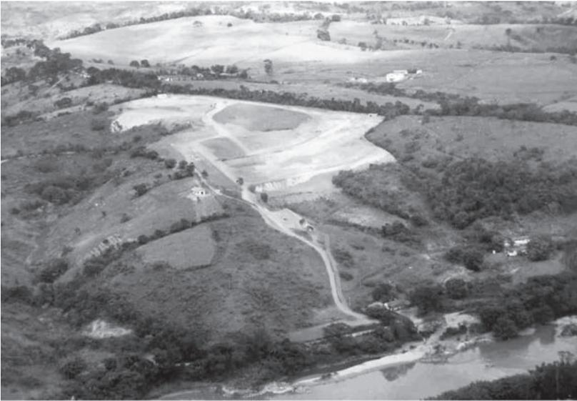
Figura 3: Remoção da cobertura vegetal para criação da infraestrutura básica da UHE-FUNIL
