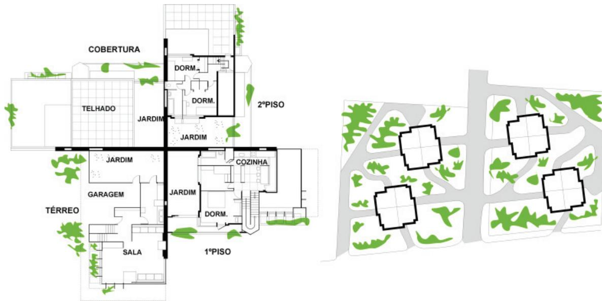
Figura 6: *Usonian suntop homes*. Esquema gráfico que permite visualizar os quatro pavimentos de cada unidade
