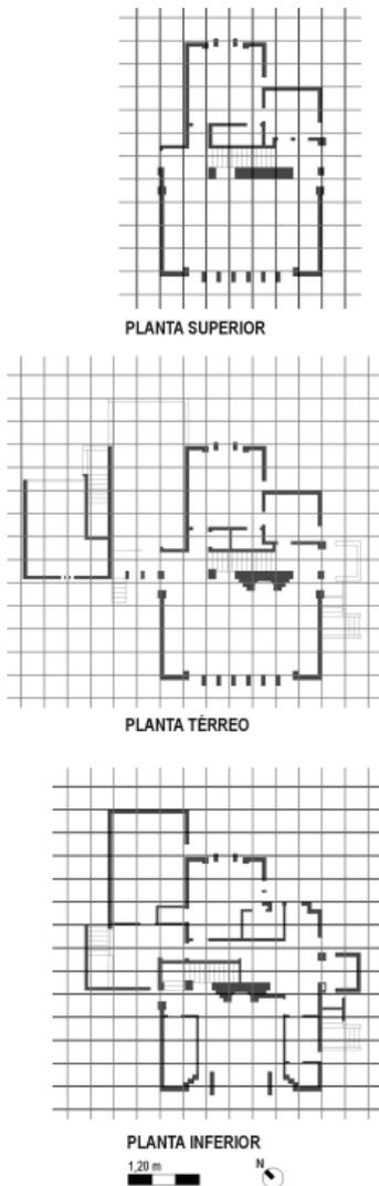
Figura 2: Plantas com diagrama da modulação quadrada da residência Textile Block Alice Millard, Pasadena, 1923
