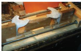
Figura 35: Início da construção do apoio do braço horizontal
