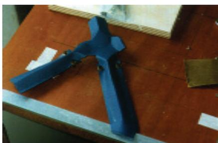
Figura 41: Experimento de reforço e enrijecimento, com folha de latão da parte inferior da aba triangular da peça
