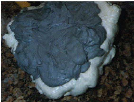
Figura 5: Resina poliéster despejada no molde negativo
