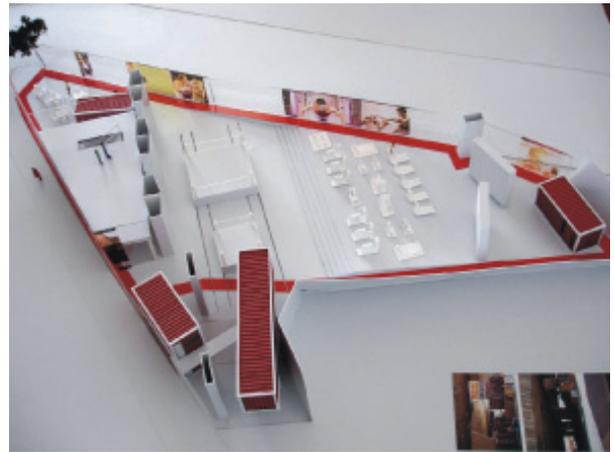
Figura 4: Facilmente deslocáveis, os ringues deslizantes no centro possibilitam reconfigurações momentâneas do espaço. Os ringues móveis se justificam em função de certas exigências programáticas: constituição de uma praça de eventos, com o ringue maior ocupando o centro, ou a liberação de uma área de carga e descarga de doações em uma faixa entre o mezanino e os contêineres. Dois grandes arquivos pivotantes separam e integram o espaço de ginástica da área para cursos técnicos nos fundos da área
