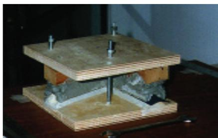
Figura 40: Molde e contramolde prensando folha de papel, com espessura dupla de 180 g/m<sup>2</sup>
