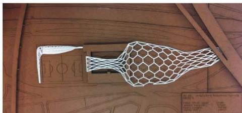
Figura 5: Equipe A – detalhe da cobertura com controle da entrada de sol.
