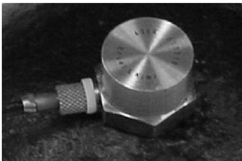
FIGURA 2 - Acelerômetro Triaxial da Bruel &amp; Kjaer Tipo 4366.
