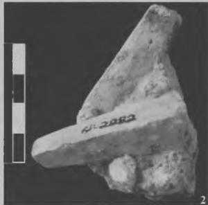
Fig. 95. Cones pirométricos apoiados sobre base de cerâmica refratária, ainda não utilizados
